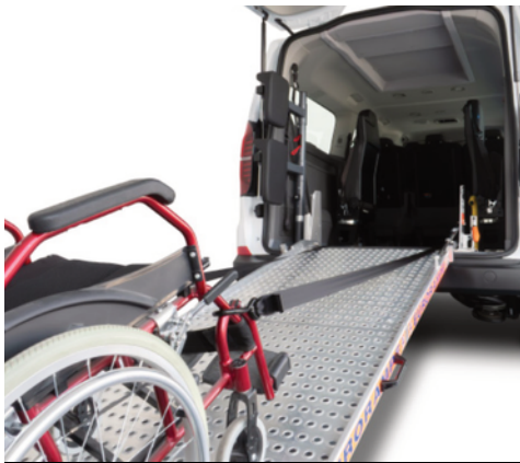
Ancajes extra largos para la sujeción de la silla de ruedas.
