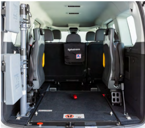
Su sistema EASYFLEX permite abatir la rampa y aprovechar el maletero.
