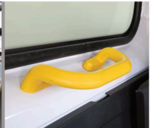
Asidero en zona PMR, para mayor confort del pasajero en silla de ruedas.
