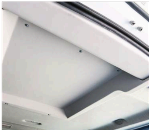
Acondicionamiento de altura interior. Aumento de la altura en la zona destinada para el pasajero en silla de ruedas hasta un total de 1.400 mm.
