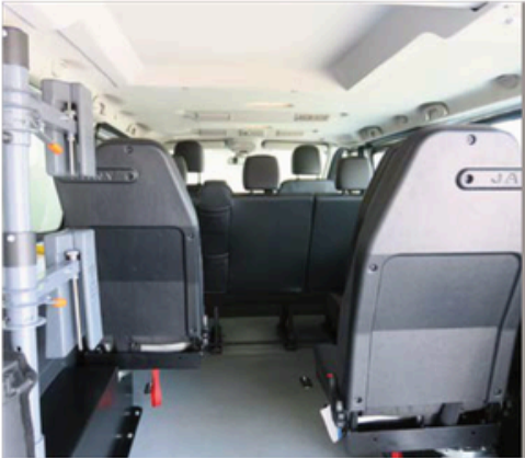
Vehículo accesible para silla de ruedas, con una capacidad total de 9 plazas, gracias a los 3 asientos giratorios y abatibles ubicados tras la 2ª fila de asientos originales.
