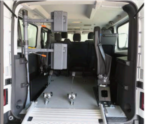
Respaldo y reposacabezas FUTURESAFE para el pasajero en silla de ruedas. Sistema abatible hacia el lateral del vehículo para maximizar espacio en el interior
