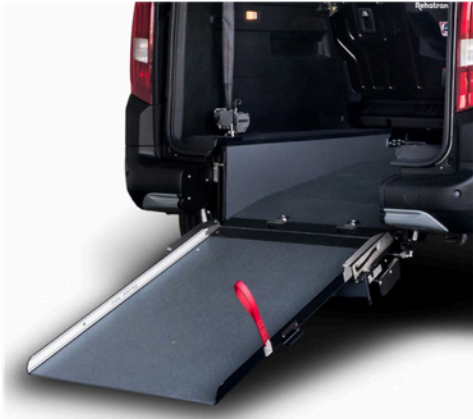
Rebaje de Piso con rampa de acceso manual. Ligera y resistente con capacidad de carga de hasta 350 Kg.
