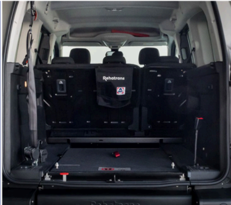
El sistema Eaxyflex permite abatir la rampa y aprovechar el maletero o utilizar los asientos opcionales en 3ª fila.
