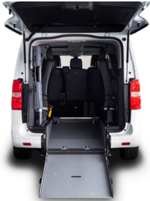
Rebaje de Piso con rampa de acceso manual. Ligera y resistente con capacidad de carga de hasta 350 Kg
