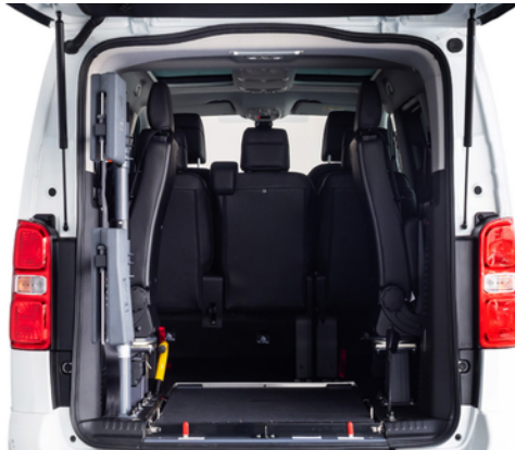
El sistema Easyflex permite abatir la rampa para aprovechar toda la capacidad del maletero o utilizar los 2 asientos opcionales en 3ª fila.
