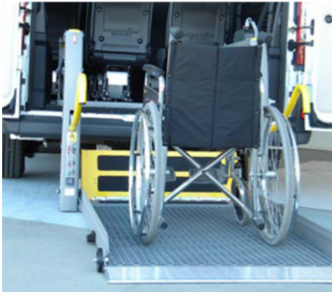
Plataforma elevadora eléctrica que admite hasta 400kg. de carga para acceder al vehículo.
