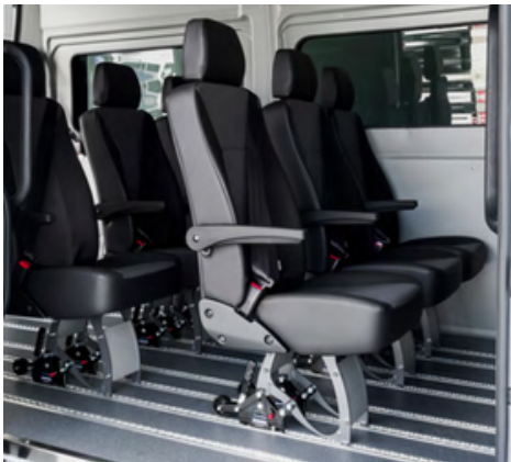
El suelo Smartfloor permite configurar los asientos con total flexibilidad
