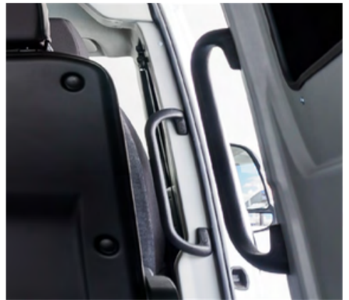
Asidero en pilar B y pilar C
