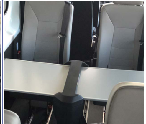
Mesa móvil en opción, fácil de plegar y con cierre suave. Se puede recoger entre asientos para ahorrar espacio.
