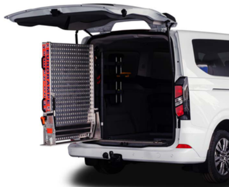
Rampa manual pivotante para facilitar el acceso al interior.
