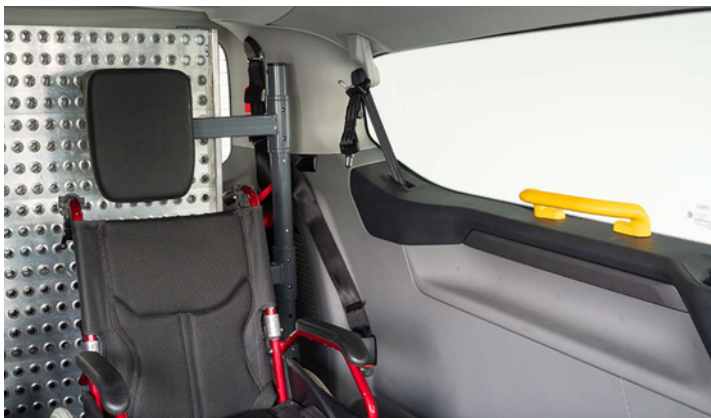
Asidero en zona PMR.
