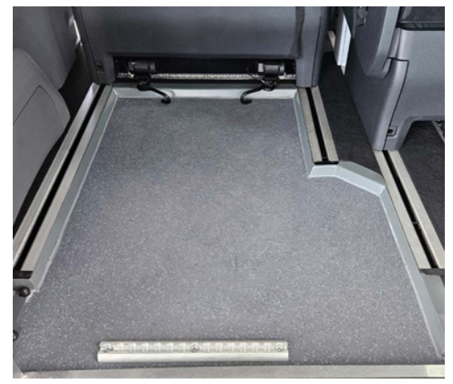
Modificación suelo interior para el fácil acceso en silla de ruedas.
