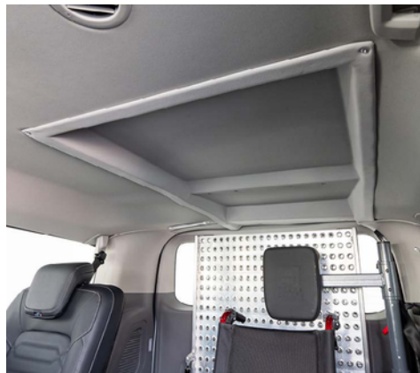
Modificación del techo interior aumentando la altura destinada al pasajero en silla de ruedas.
