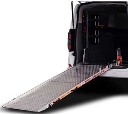
Rampa desplegable para acceder cómodamente al vehículo en silla de ruedas.
