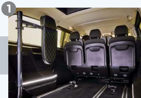
1 Instalación de respaldo y reposacabezas de apoyo PMR.
