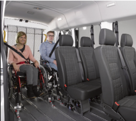
El suelo Smartfloor dota al vehículo de una gran flexibilidad a la hora de configurar el interior
