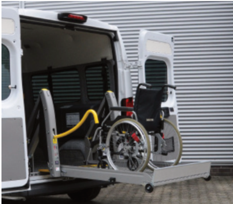
Gracias a la plataforma elevadora, se puede acceder al vehículo cómodamente en silla de ruedas
