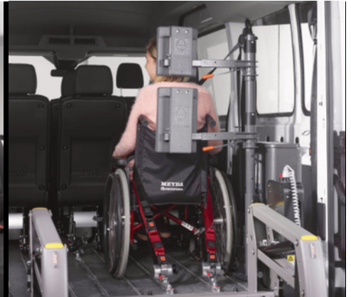
Opcionalmente, se puede equipar el vehículo con un respaldo y reposacabezas FUTURESAFE
