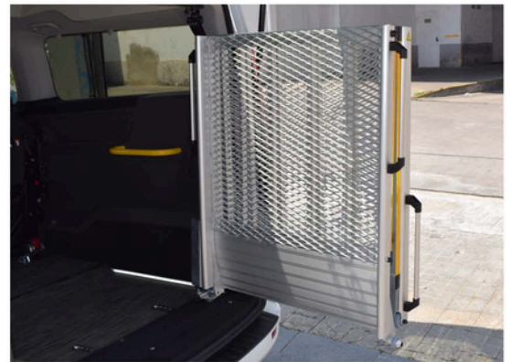
4- Rampa manual. Con kit giratorio para mayor comodidad a la hora de cargar y descargar equipaje.
